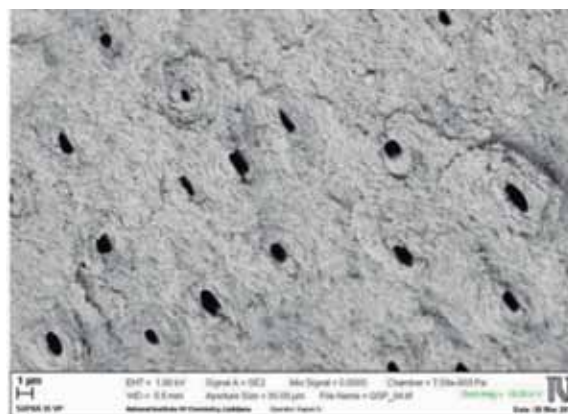
Figura 62. SEM x 200 y x 1000 Tratado con láser Er:YAG con modo QSP. La superficie es regular, sin smear layer y con los túbulos dentinarios abiertos. Adaptada de Matjaz L, Malej N, Pirnat S. (45).
